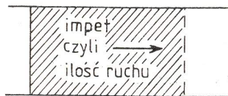
Rys. 6. Prawo swobodnego spadku: stała siła powoduje jednostajny wzrost ilości ruchu — impetu
